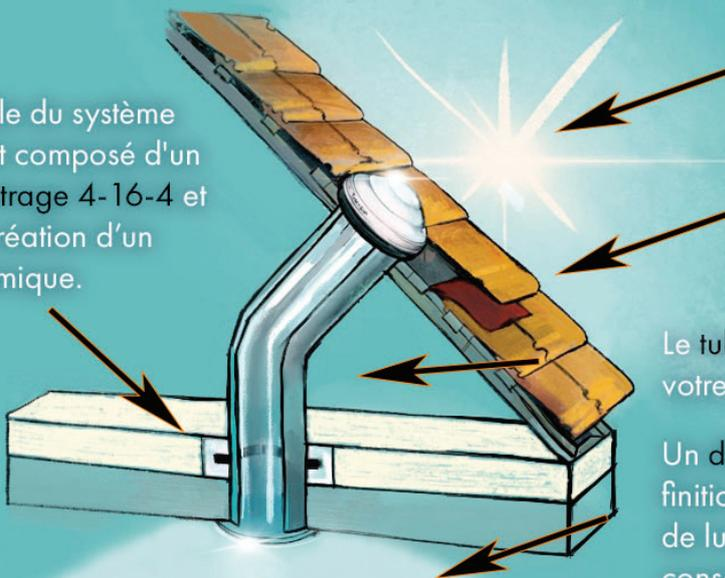
Le dôme en cristal collecte la luminosité à 360° et réoriente la lumière dans le tube.
